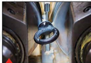
Machine à rouler ESCOFFIER Ø12 pas trap de 3 à Ø40 pas trap de 7
