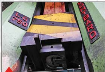
Ligne de forge Marteau pilon Montbard LG 750 1700 Kg/m - pièces de 40 à 2200 g
